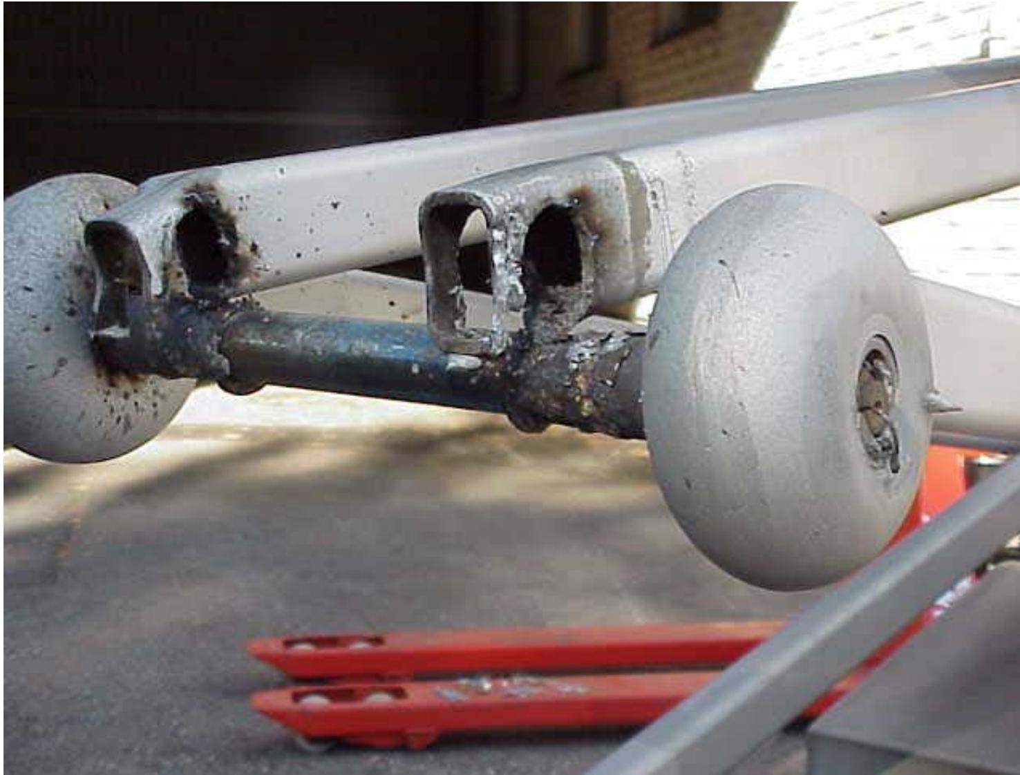
Rottura sezionatore per sovraccarico – (black out in Svezia, estate 2003)
